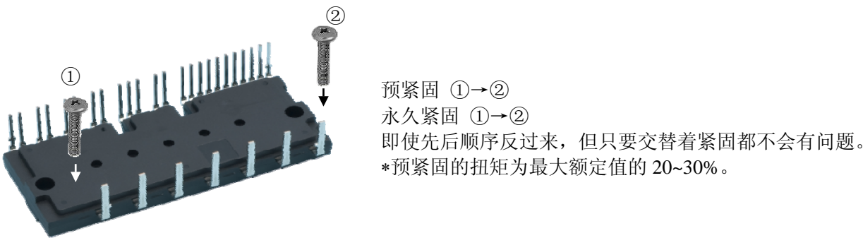
图 2.19 推荐螺钉紧固顺序
