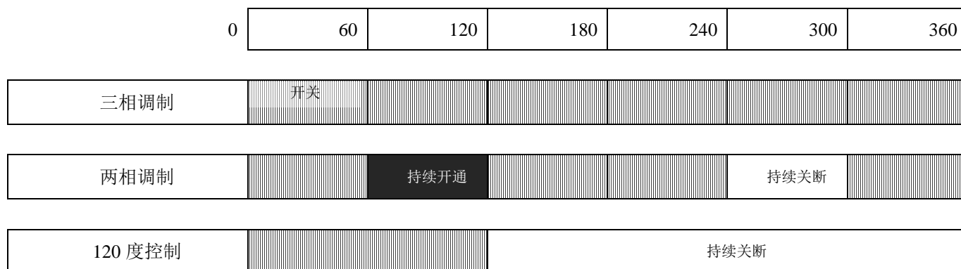
图 1-36 三种调制方法的开关状态区别
